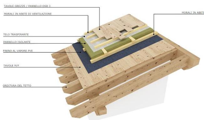
Il tetto sarà realizzato in legno lamellare con travi, travetti ed assito, al di sopra del quale verrà eseguito il seguente pacchetto ventilato di coibentazione ed impermeabilizzazione.
