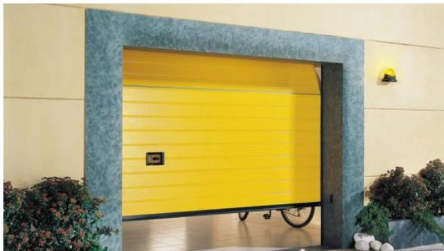
due lamiere a taglio termico e interposto isolante in poliuretano espanso anigroscopico, al cui interno viene inserito un piatto di rinforzo per il fissaggio stabile delle cerniere e di tutti gli accessori applicati sul manto. Il pannello di base e il superiore sono provvisti di profilo alluminio e guarnizione di tenuta in EPDM, montate anche sulle guide laterali per una perfetta tenuta all'aria. Il sollevamento avviene tramite tamburi in alluminio pressofuso, sui quali si
